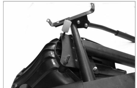
Den Sitz (A) an den 4 Bohrungen der zentralen Platte des Hauptgestells (C) positionieren. Die beiden Schrauben (I) in die 2 vorderen Bohrungen einfügen. Die beiden Schrauben von den Dämpfungslagern (H) abschrauben und in die 2 hinteren Bohrungen einfügen. Alle Schrauben mit einem Inbusschlüssel (N) anziehen.
