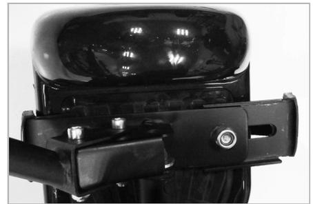
Die Mutter des Bügels am Hauptgestell (C) abschrauben und die Länge auf der Grundlage der Abmessungen des verwendeten Hoverboard einstellen.
